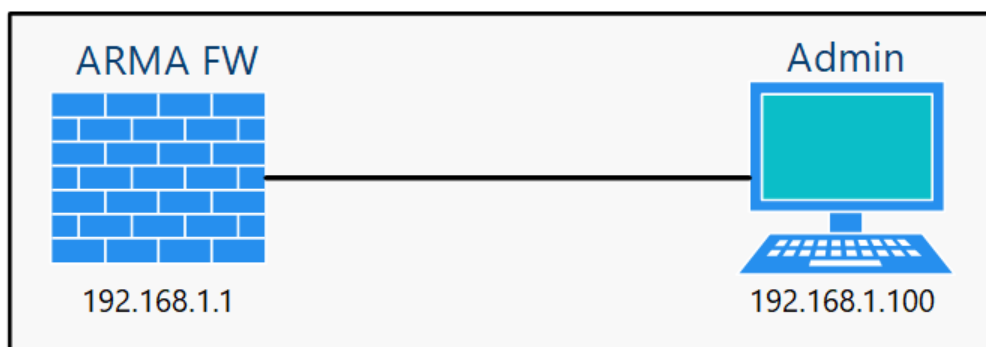
Рисунок – Схема стенда для проверки SNMP
